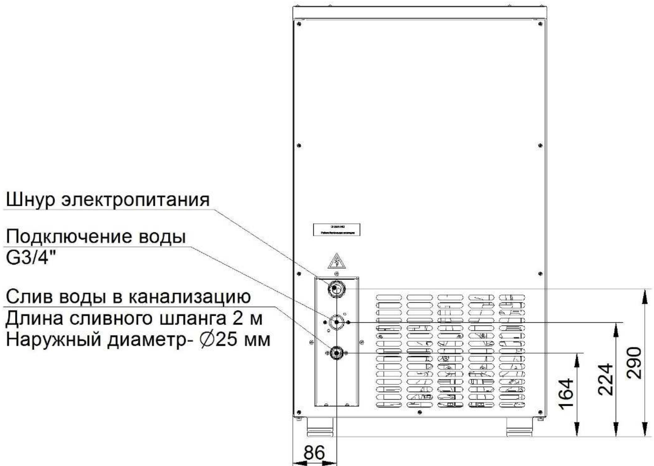
Рис. 4 Схема подключения льдогенератора
