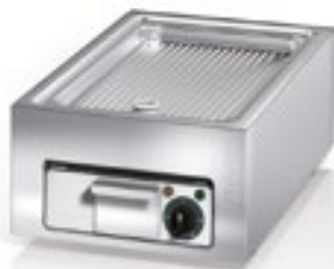
Грили с рифленой или гладкой поверхностью – на бесшовно сварной поверх- ности гриля создается единая температура. Лишний жир собирается в большом поддоне. У гриля с двойной шириной отдельно регулируемые зоны нагрева обеспечивают подключение дополнительной мощности.
