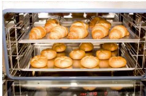
Конвекционные печи Abat с электронной панелью управления позволяют полностью контролировать процесс приготовления продуктов, а также записывать до 99 собственных четырехэтапных программ приготовления. Впрыск воды осуществляется автоматически с заданной периодичностью. Отпадает необходимость в визуальном контроле процесса приготовления. Возможность приготовления продуктов в ручном режиме.
