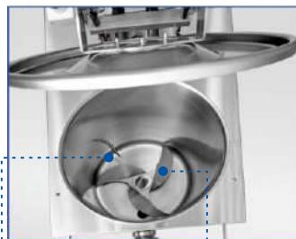
Кювета оснащена мешалкой (пропеллером) и датчиком температуры
