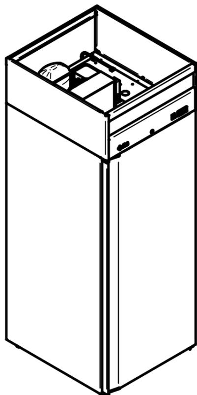
Шкаф холодильный типа ШХ-0,7 (ШХн-0,7;ШХс-0,7) с верхним расположением агрегата предназначен для хранения пищевых продуктов в охлаждённом или замороженном состоянии на предприятиях общественного питания и торговли.
