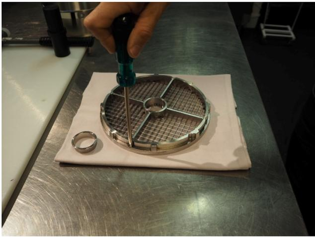
3. Выкрутите винты Nylock, крепящие внешнее запирающее кольцо, расположив решетку на мягкой поверхности, чтобы предотвратить повреждение режущих лезвий.
