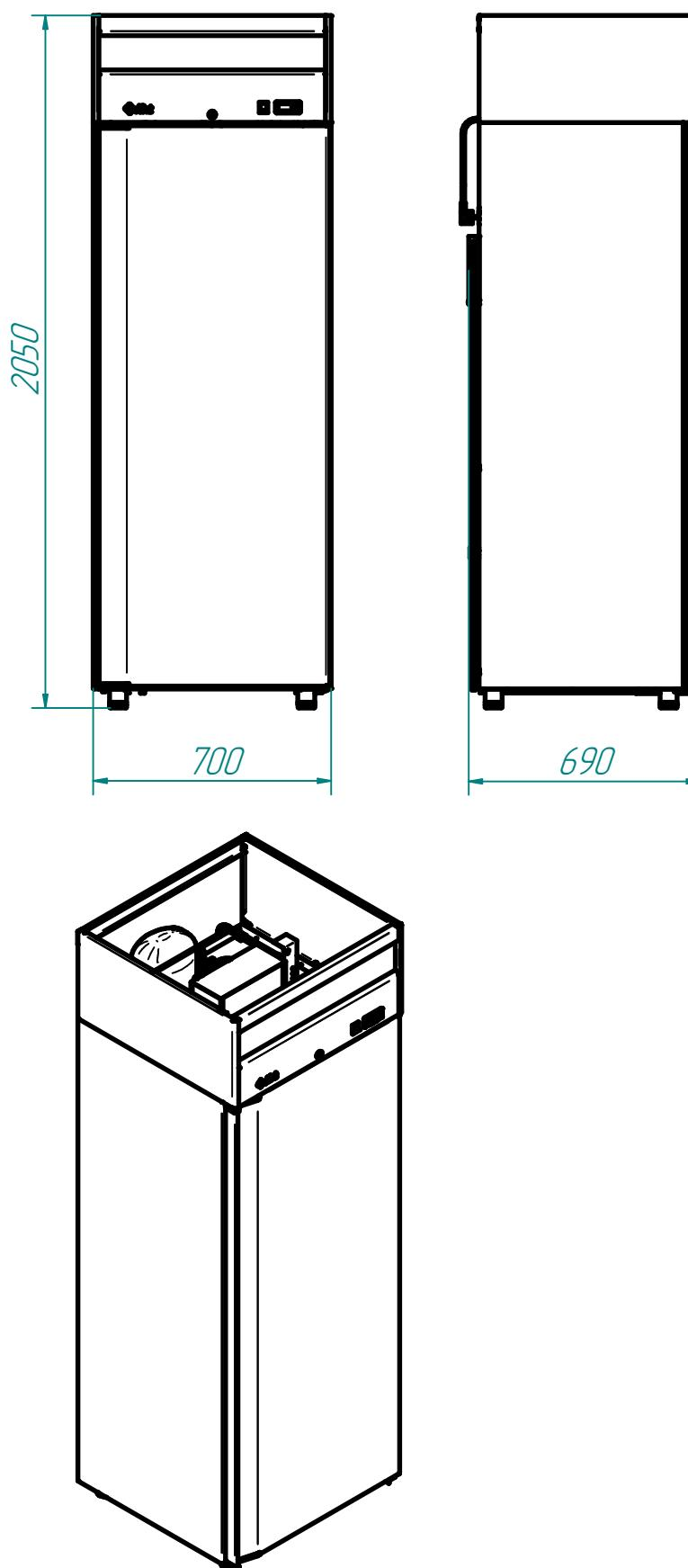
Шкаф холодильный типа ШХ-0,5 (ШХн-0,5;ШХс-0,5) с верхним расположением агрегата предназначен для хранения пищевых продуктов в охлаждённом или замороженном состоянии на предприятиях общественного питания и торговли.
