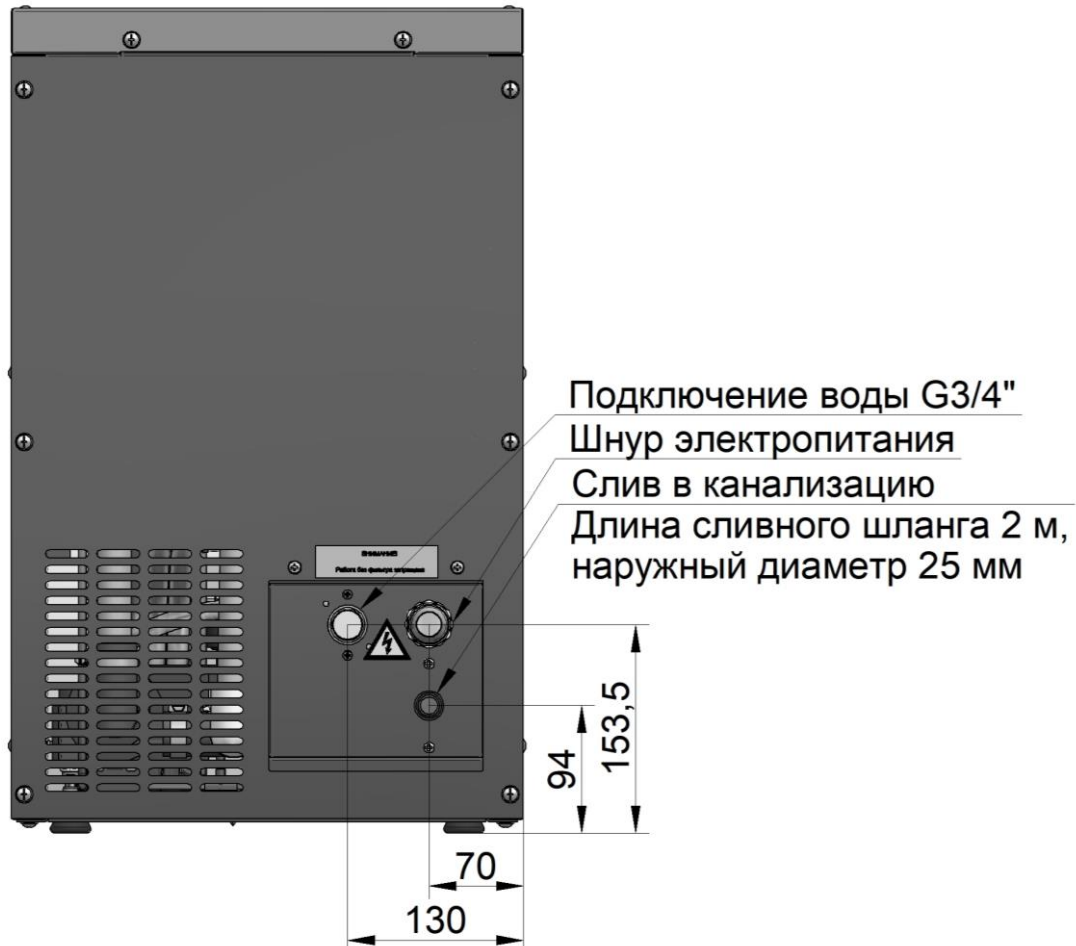
Рис. 5 Схема подключения льдогенератора
