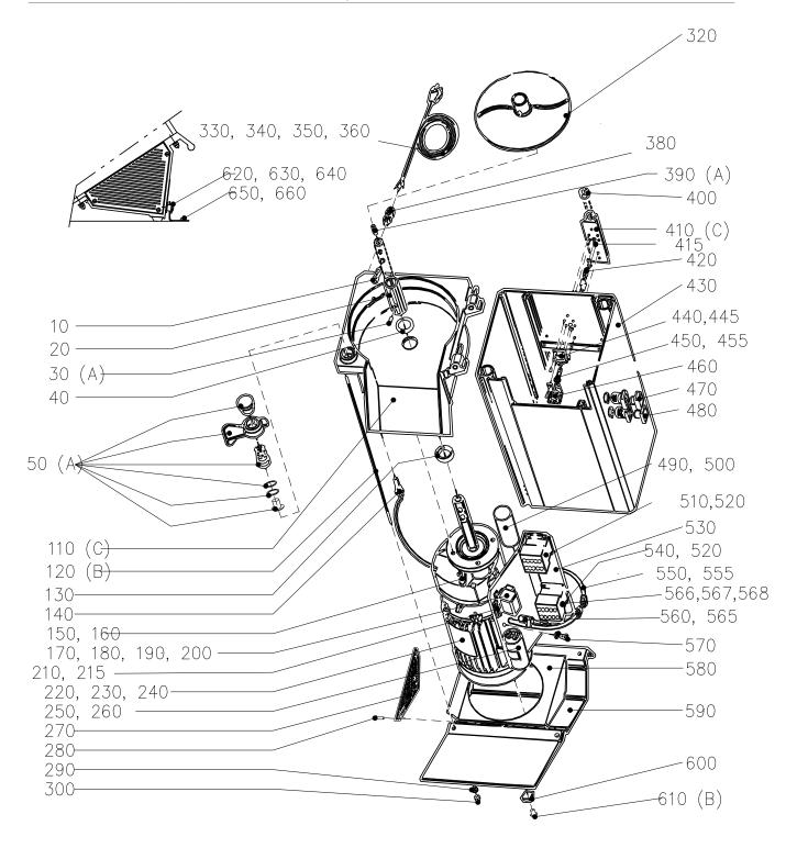
A: LOCTITE NO.242 B: LOCTITE NO.243 C: SILICONE RTV 108 ALL THE WAY AROUND HOUSING
